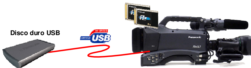
Figura: uso de la función USB Host con un disco duro externo
